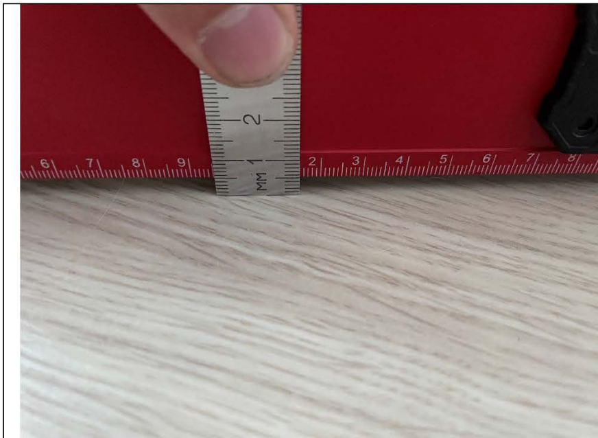
Фото №19. Измерение отклонения уровня пола в детской.
